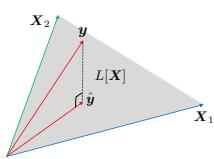
図 2.1:  $n = 3$ ,  $p + 1 = 2$  の場合の最小二乗法による推定の図示。 $\mathbf{X}_1$ ,  $\mathbf{X}_2$  はそれぞれデザイン行列  $\mathbf{X}$  の第 1 列, 第 2 列からなるベクトルに対応している。グレーの平面が  $L[\mathbf{X}]$  に対応する。
